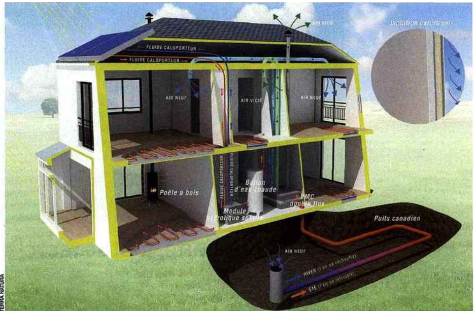
Les 21 maisons, accolées par deux ou trois, sont isolées par l'extérieur et dotées d'un bow-window de 8 m 2 au sud protégé par des volets extérieurs à lames orientables. VMC double flux, puits canadien et chauffage électro-solaire complété par un poêle à bois permettent d'obtenir le label Minergie avec une consommation énergétique de 42 kWh/m 2 .an.
